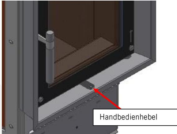
Der Bedienhebel des GOR44 ist in seiner Funktion gekennzeichnet. Drücken Sie den Hebel nach links wird die Luftzufuhr ganz geöffnet und das Feuer wird groß. Drehen Sie den Hebel nach rechts wird die Luftzufuhr geschlossen und das Feuer wird klein.
